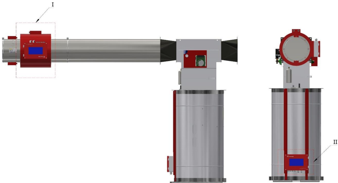
图五 a: AMP-EE01 鹰眼金属火花探除器标准安装示意图
