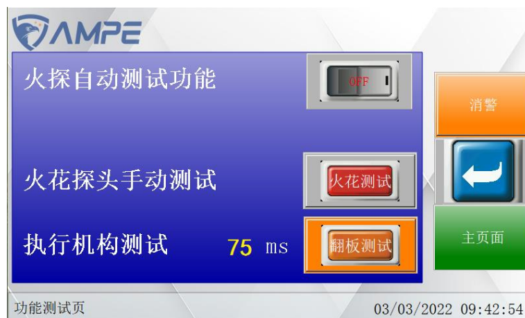
图十四 b：火探自动测试功能关闭页面
