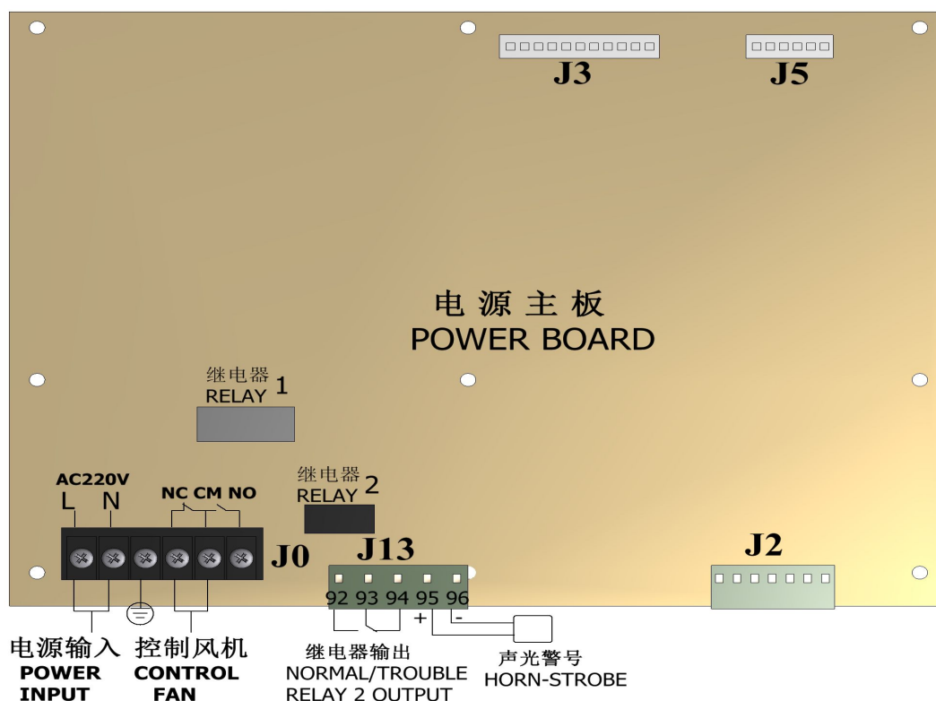
图八：电源板的电气接线
